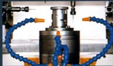
手で簡単に曲がりセットでき、しかも使用中にセット角度が変わりません。安定した給油・冷却が得られ、切削ロスが解消できます。
